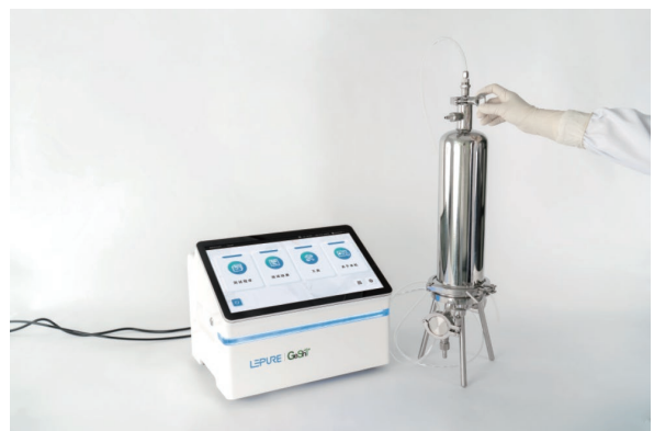
滤器管路连接和完整性测试仪气路连接图
