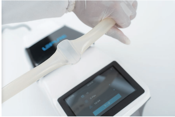
4. 封管效果确认，光滑，无气泡
