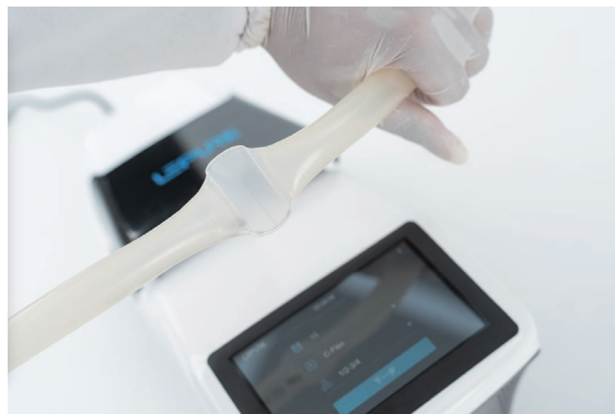
4. 封管效果确认，光滑，无气泡
